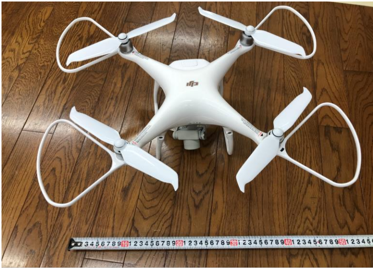
写真測量用ドローン Phantom4 Pro V2 高度約36mで飛行
