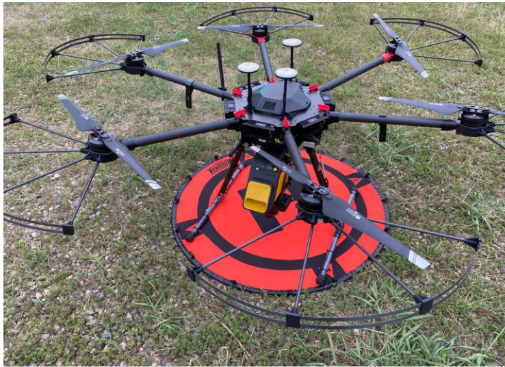
レーザ測量用ドローン Matrice600 Pro 高度約60mで飛行
